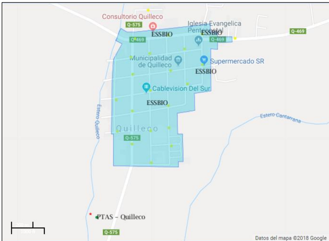
Figura 3. Cobertura de Alcantarillado y Punto de Descarga de la PTAS en Quilleco urbano
